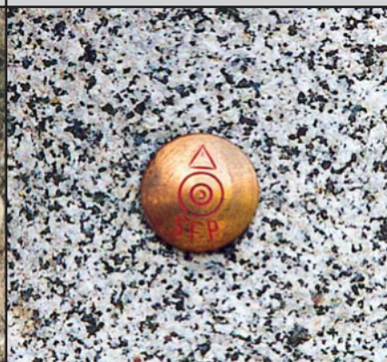
SFP Messingbolzen Ø 3 cm
